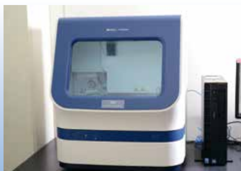
DNAシーケンサー：遺伝子の情報を読み取る装置です。
