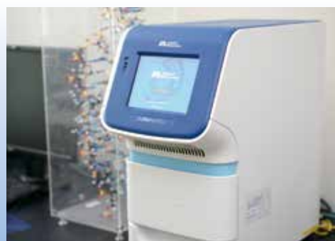
リアルタイム PCR 装置：目的の DNA を定量することができます。
